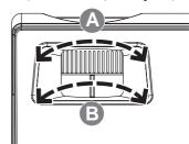
3. Для исправления геометрического искажения изображения используются кнопки Трапеция. Эти кнопки имеются как на пульте ДУ, так и на панели управления проектора.
