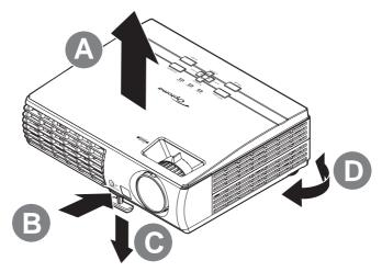
1. Для увеличения высоты проектора приподнимите проектор [А] и нажмите кнопку регулятора высоты [В].
